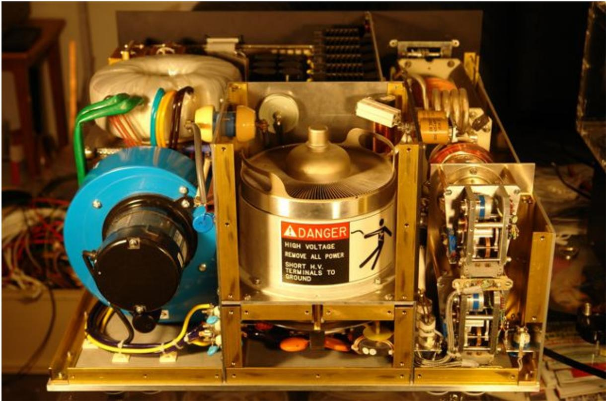
Abb. 10: Endstufe ohne Rückwand, rechts Motorantriebe für die beiden Vakuum-C's
