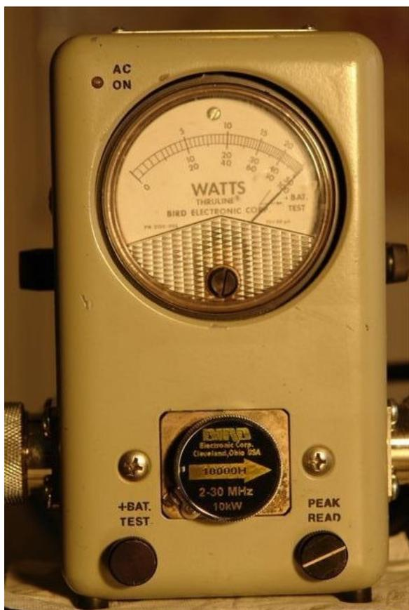
Abb.16: Nachweis der Ausgangsleistung: Bei einem Input von 70 W auf 40 m erzielte die Tsunami-Endstufe 10,1 KW Output.
